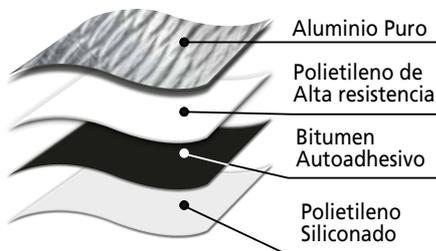
Su elevada adherencia en frío permite impermeabilizar y reparar **sin el uso de soplete**, lo que hace a este producto muy ventajoso. La superficie a aplicar debe estar seca y limpia, las superficies porosas deben tratarse previamente con Imprimador.
